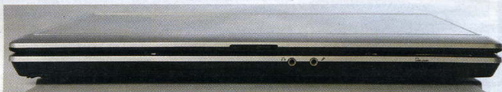
Vpředu notebooku jsou prakticky umístěny vstupy pro mikrofon a sluchátka.
