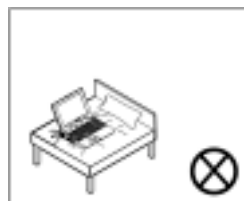
Nepokladajte počítač na povrch, ktorý by obmedzoval prístup vzduchu k ventilátorom.
